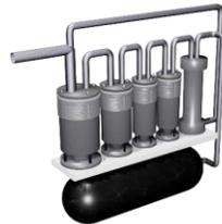
Wasserstoffverdichter mit Pufferspeicher
