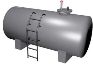
Nichtisolierter, druckloser Tank zur Speicherung von beladenem und unbeladenem LOHC in verschiedenen oder Membrantanks
