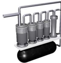
Wasserstoffverdichter mit Pufferspeicher
